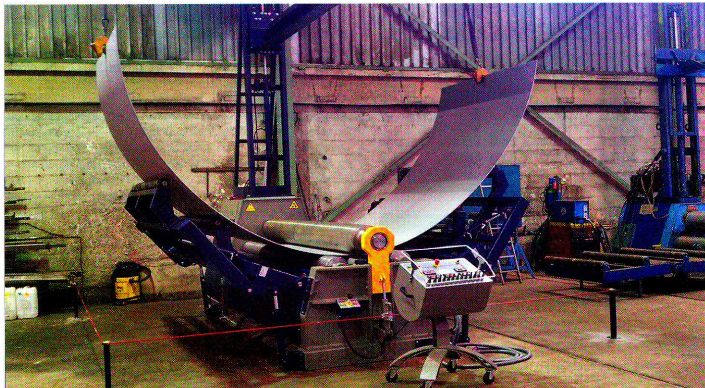
Met deze multifunctionele wals is Staalmeesters in staat platen van 3-12 mm dikte over een lengte van 3100 mm met diameters vanaf Ø400 te walsen. Dit zowel cilindrisch als conisch.
